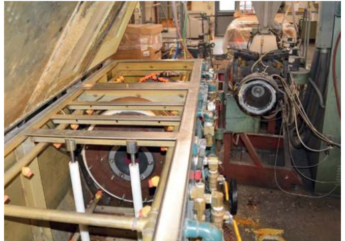
SWM国际公司位于美国宾夕法尼亚州里奇兰生产基地的真空罐
